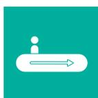
Bei Fahrsteigen handelt es sich um eine spezielle Form von Fahrtreppen. Sie kennzeichnen sich dadurch, dass die umlaufenden Bänder keine Stufen aufweisen und damit vollkommen eben verlaufen. Die Bänder können sich beispielsweise aus Paletten oder Gurten zusammensetzen. Sie befördern Personen zwischen Ebenen, die zumeist auf der gleichen Höhe liegen.
