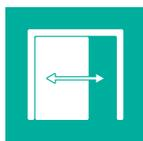
Ein Schiebetor bezeichnet ein durch horizontales Schieben zu öffnendes Tor. Bodenlaufende Schiebetore bewegen sich dabei auf einer Laufrolle. Diese Torart findet immer dort Einsatz, wo der Eingangsbereich besonders breit ist und den Einbau von großen und schweren Flügeln erschwert.
