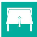
Zu den wesentlichen Typen von Garagentoren zählen Kiptore. Sie verfügen über einen Stahlrahmen, der durch eine Hebelarmkonstruktion beim Öffnen nach außen schwingt. Der Torflügel des Schwingtores besteht aus einem einflügeligen, verzinkten Stahlblechelement, das in der Regel lamellenförmig geprägt ist.
