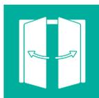
Bei Drehflügelatoren kann die gesamte Rauminnenfläche optimal genutzt werden, da das Tor nach außen öffnet. Es gibt ein-, zwei- oder mehrflügelige Tore. Die großen Flügel drehen dabei wie übliche Drehflügeltüren um die seitliche Rotationsachse, jedoch in größeren Dimensionen.
