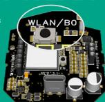
**A2. Spannung abschalten, 10 Sekunden warten** → Spannung wieder einschalten, warten bis grüne LED zu blinken aufhört
