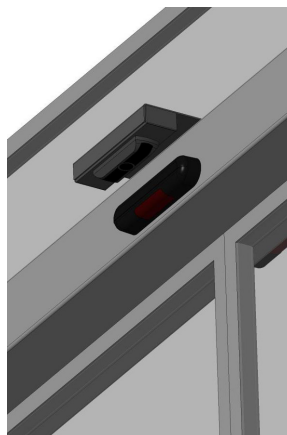
Einbauvarianten A oder B für Montagesatz Türantrieb
