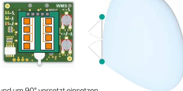
Zum Drehen die Radar-Antenne vorsichtig herausziehen und um 90° versetzt einsetzen.
