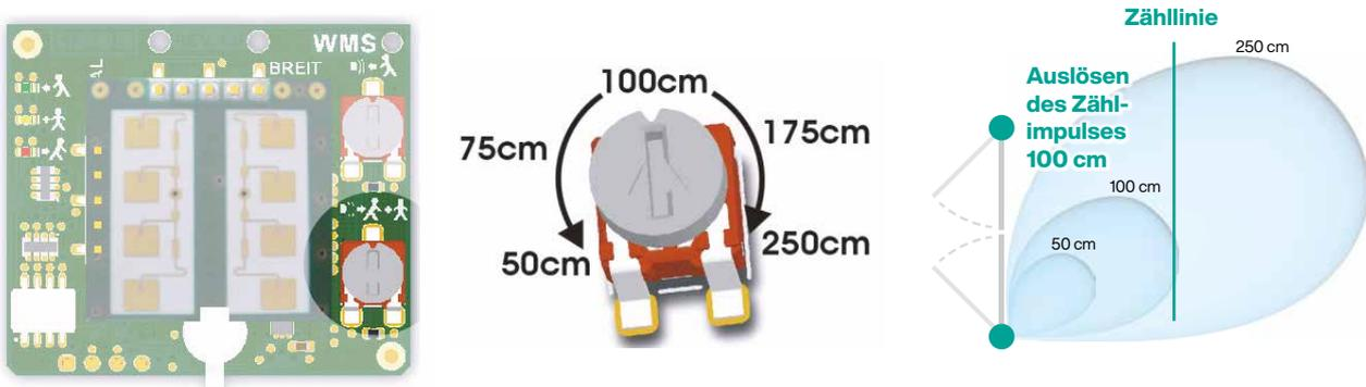
Potentiometer drehen, um die Größe des Erfassungsfeldes der Entfernungserfassung und des Zählimpulses (Zähllinie) zu ändern, damit beim Überschreiten der Zähllinie in Richtung Entrance Gate der Zählimpuls ausgelöst wird.
