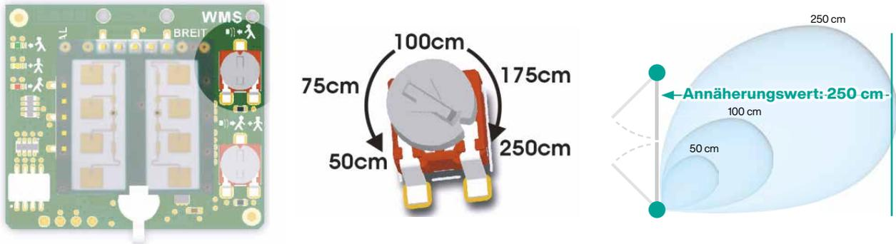
Potentiometer drehen, um die Größe des Erfassungsfeldes der Annäherungserfassung zu ändern. Mit der Größe des Erfassungsfeldes wird der Zeitpunkt des Impulses für die Gateöffnung bestimmt.
