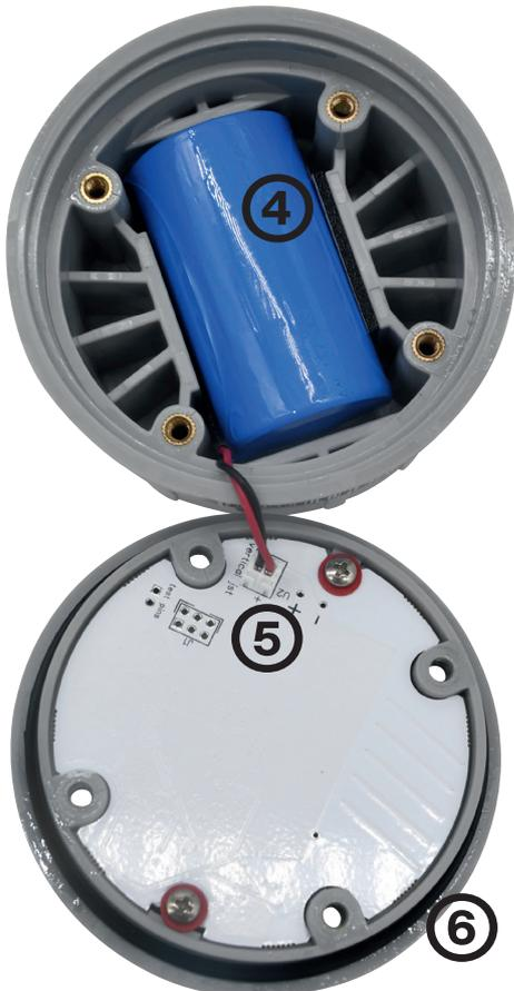
Die **3,6 VDC Lithium-Primärzelle ④** ist in der vorgesehenen Vertiefung eingelegt und über den **Steckanschluss ⑤** mit der Platine des Geräts verbunden.
