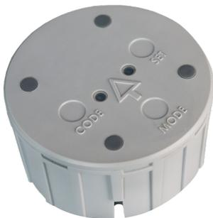
Der LRM-088 ist ein drahtloser, elektronischer Schleifendetektor der Baureihe e-LOOP EL00IG-RAD. Die E-Schleife ist ein batteriebetriebenes Detektionsmodul für den Bodeneinbau zur Erfassung von Fahrzeugen auf der Basis eines Magnetfeldsensors mit integriertem Radar. Damit werden Fahrzeuge dynamisch und statisch erfasst.
