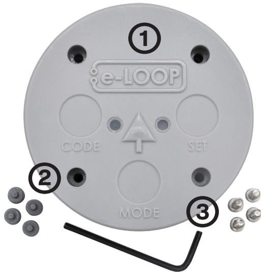
Die **Deckplatte ①** des LRM-088 gewährleistet die Schutzart IP68. Um an die Batterie zu gelangen, muss die Deckplatte abgenommen werden. Hierfür sind die **vier Schutzkappen ②** zu entfernen und die **vier Sechskantschrauben ③** mit dem im Lieferumfang enthaltenen Imbusschlüssel zu lösen und zu entfernen.
