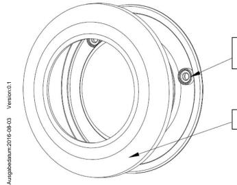
Montage des kapazitiven Tasters mit drei Zylinderkopfschrauben M4
